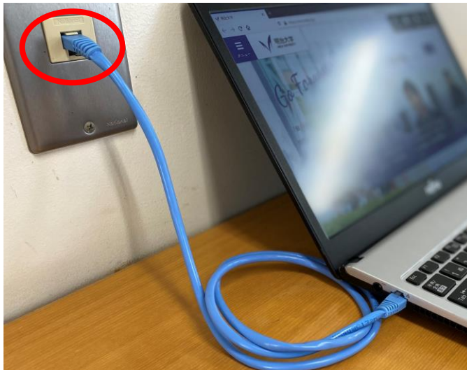
(図 1-1) LAN ケーブルの接続
