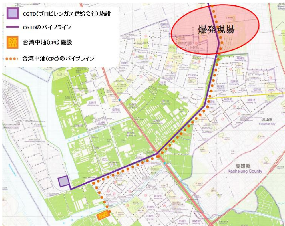
図 3. 高雄市内の石油化学工場、パイプライン、及び爆発現場の位置関係
